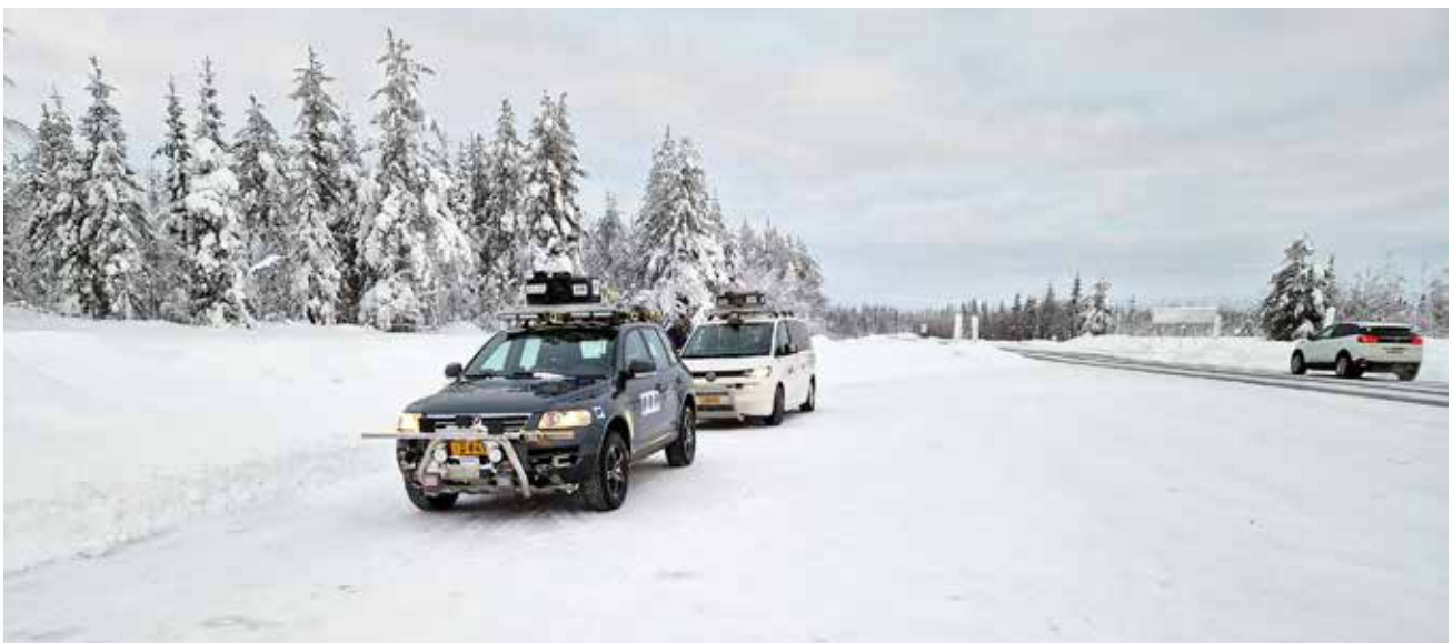
Muoniossa toimii VTT:n viiden kilometrin koeajorata. Robottiautoa opetetaan selviämään äärimmäisissä liikennesuhteissa.
