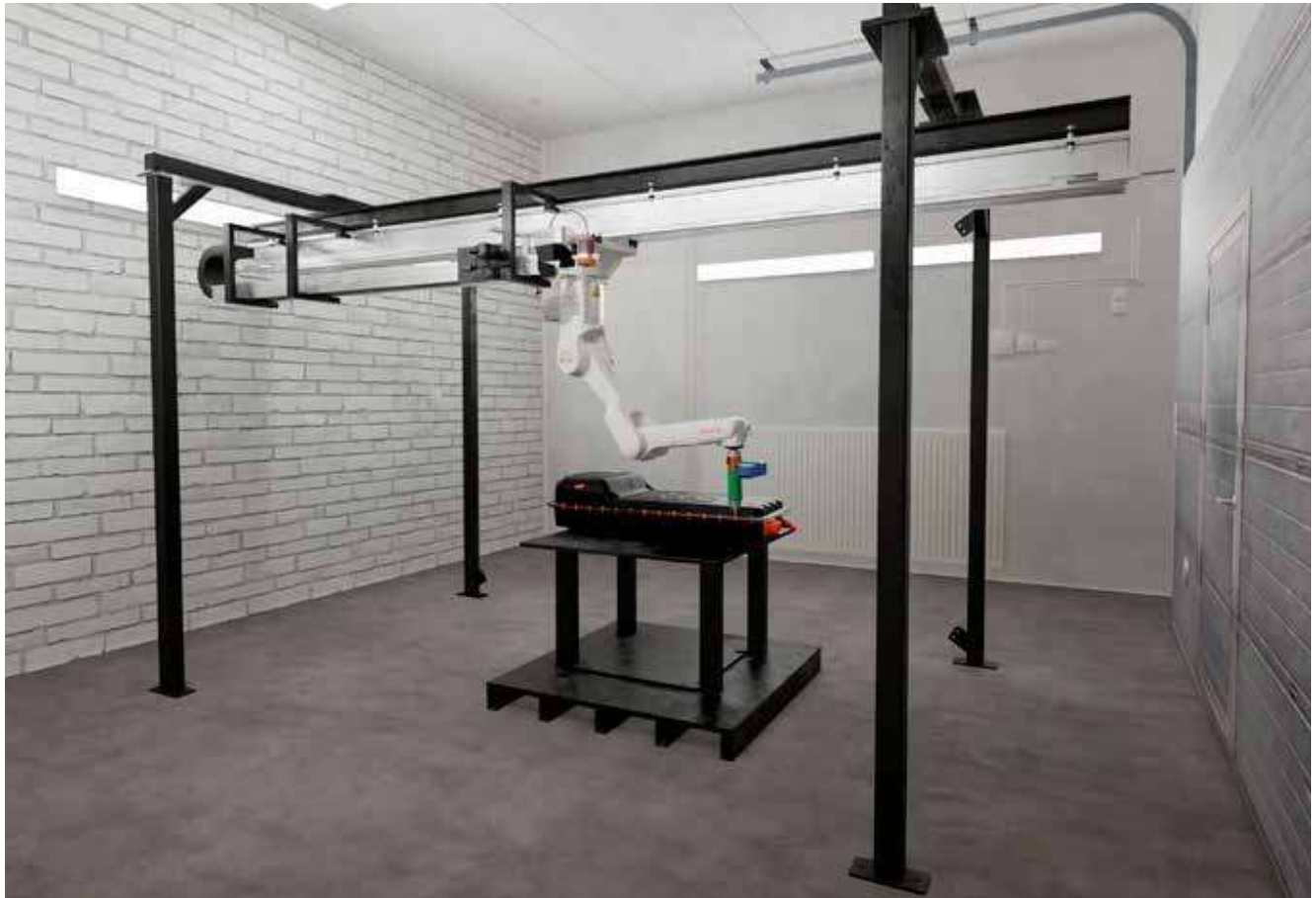
Suunnittelukuva Centrian robottisolusta, työn alla Ford Transitin ladattavan hybridin akku. (Kuva: Centria, 2024)
