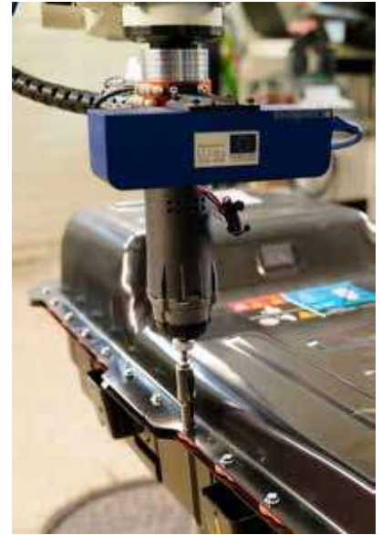
Ruuvien tyyppin ja paikan tunnistaminen kone- näön ja tekoälyn avulla. Oikealla liittimien irrottaminen 2-sormisella tarttujalla. (Kuva: Centria, 2024)
