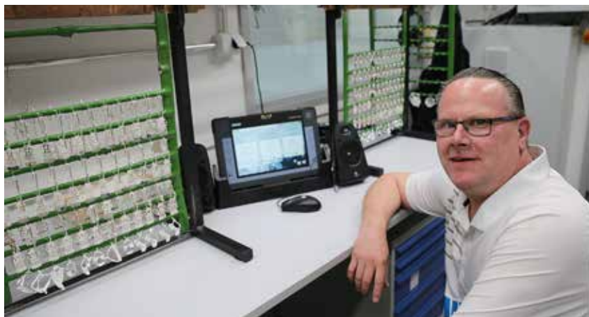
Pintakäsittelijä Petri Tallberg lastaa korut telineisiin optimaalisella tavalla ja valitsee niille tablettitietokoneelta halutun pinnoituskäsittelyn. Enää hänen ei tarvitse nostella raskaita telineitä altaasta toiseen.
