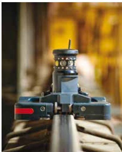
Konecranes RailQ -ratamittauksessa käytetään kauko-ohjattua robottia yhdistettynä silmämääräiseen tarkastukseen.
