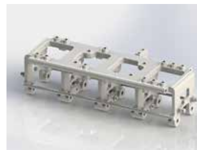
Tulostamalla valmistettu tarttujan runko on siisti ja kompakti. Kappaleessa on valmiina ilmakanaavat ja liikkuvien osien laakerointipisteet.
