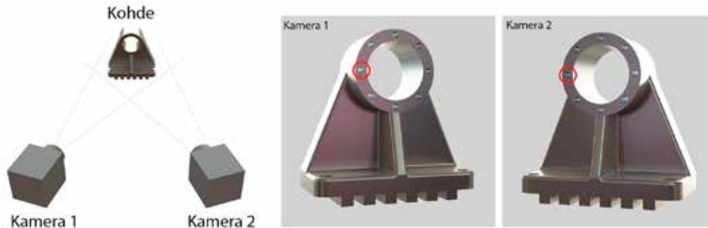
Kuva 2. 3D-kuvauksen toimintaperiaate ja vastinpisteet.
