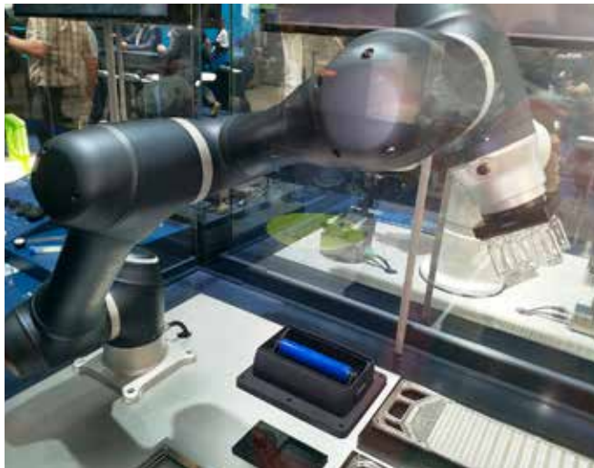
ADHESO tartunta tässä ryhmään lasisia näytempulloja ilman ulkoista voimaa. Huom puhdistusrullaa tarvitaan.
