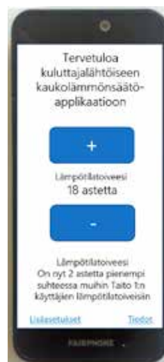
Kuluttajakäyttöliittymä kaukolämmön säätöön.
