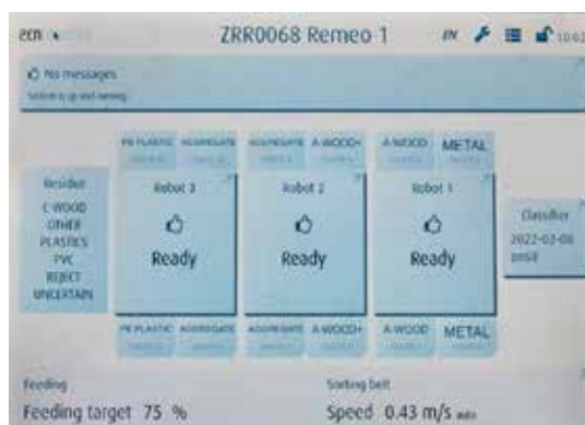
Lajittelurobotin ohjauspaneelista valitaan muun muassa, mitä materiaaleja ja millä tarkkuudella kukin robottikäsi poimii.
