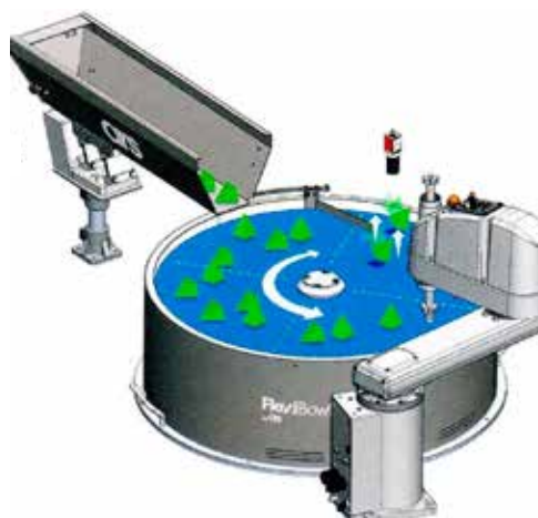
Pienosien syöttö on muuttunut kamerajärjestelmien myötä helpommaksi, FlexBowl®.
