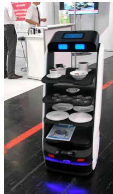
Messustandien kahvit hoituivat automaation hengessä Keenon-tarjoilurobotilla. Navigointi ilman markkereita SLAM-tekniikan avulla.
