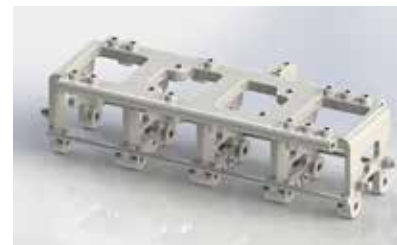
Tulostamalla valmistettu tarttujan runko on siisti ja kompakti. Kappaleessa on valmiina ilmanakanavat ja liikkuvien osien laakerointipisteet.
