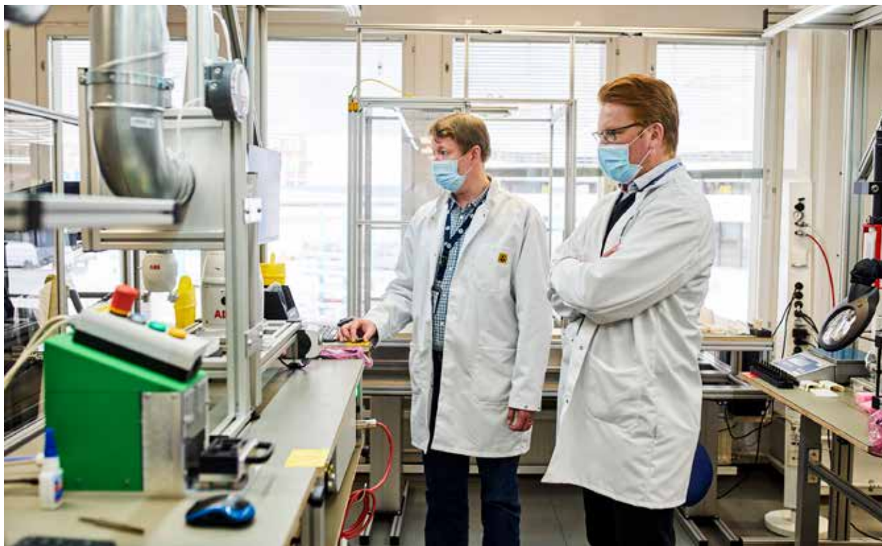
ABB:n Single-arm YuMi -cobotti hoitaa komponentin kokoonpanossa liimaustyövaiheen, joka on ihmiselle erittäin vaikea toteuttaa tasalaatuisesti”, kertovat tuotannollistamishankepäällikkö Teemu Äärynen (vas.) ja Helsingin tehtaan operaatioista vastaava Sami Kyllönen (oik.) GE Healthcarelta
