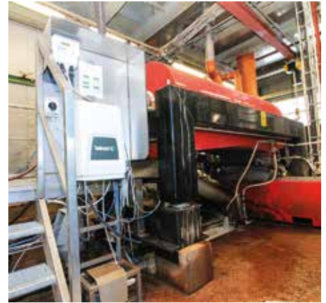
Valmet Low Solids Measurement (Valmet LS) mittaa rejektiveden kiintoainepitoisuutta alhaisissa kiintoainepitoisuuksissa (0-5000 mg/l).
