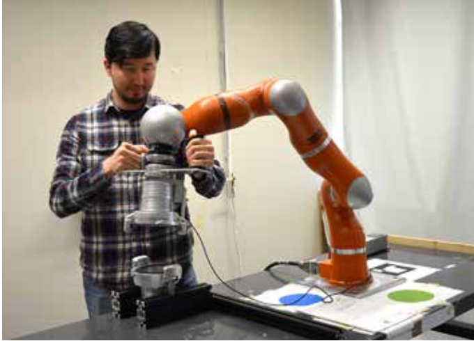
KUKA LWR4- robotin voi opettaa kädestä pitäen liittämään putkiläiittimet yhteen kontaktivoimia hyödyntäen.
