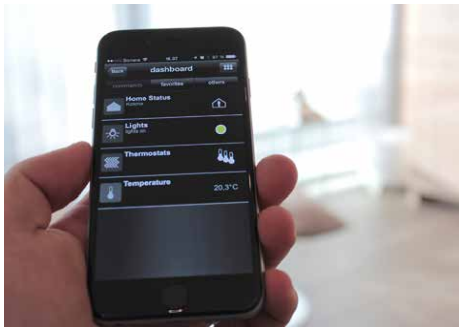
Talotekniikan hallinta on mahdollista yhdestä käyttöliittymästä ja toimii sekä paikallisesti että etänä.
