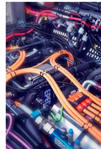
EV-1:ssä on Epecin uusi Epec Flow -järjestelmäratkaisu, joka sisältää sähkökäyttöisen voimainlinjan ja tehonjakoyksikön sekä voimainlinjan ohjausyksikön.
