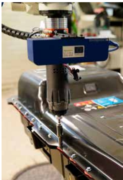
Ruuvien tyyppin ja paikan tunnistaminen konenäön ja tekoälyn avulla. Oikealla liittimien irrottaminen 2-sormisella tarttujalla. (kuva: Centria, 2024.)
