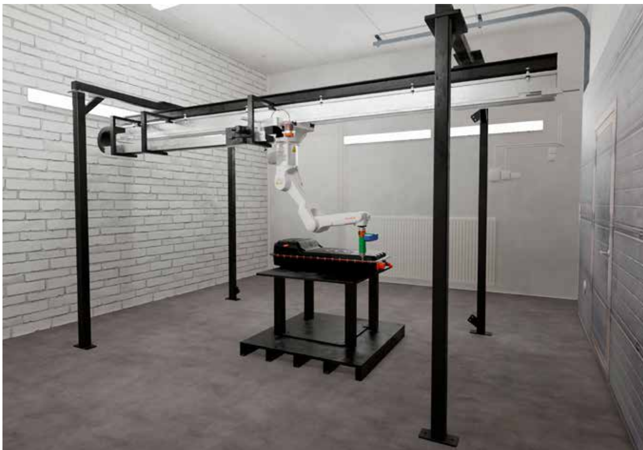
Suunnittelukuva Centrian robottisolusta, työn alla Ford Transitin ladattavan hybridin akku. (kuva: Centria, 2024.)
