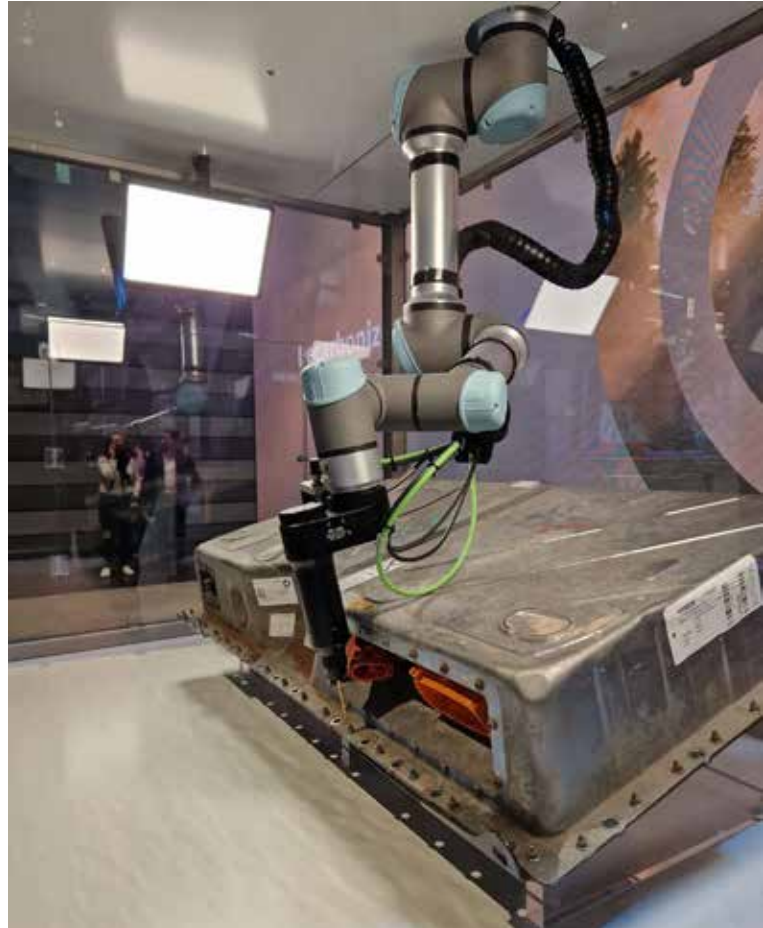
Siemens esitteli marraskuussa 2023 Saksassa järjestetyillä SPS-messuilla Schmidin tiimin kehittämän skaalattavan robottidemon, jolla sähköauton akun purkaminen onnistuu automaattisesti.
