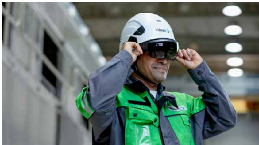
Microsoftin Hololens ratkaisulla voidaan näkökenttään tuoda informaatiota suoraan automaatiojärjestelmästä liittyen nähtävillä olevaan laitteeseen. Eleisiin perustuva ohjaus vaatii paljon harjoittelua.
