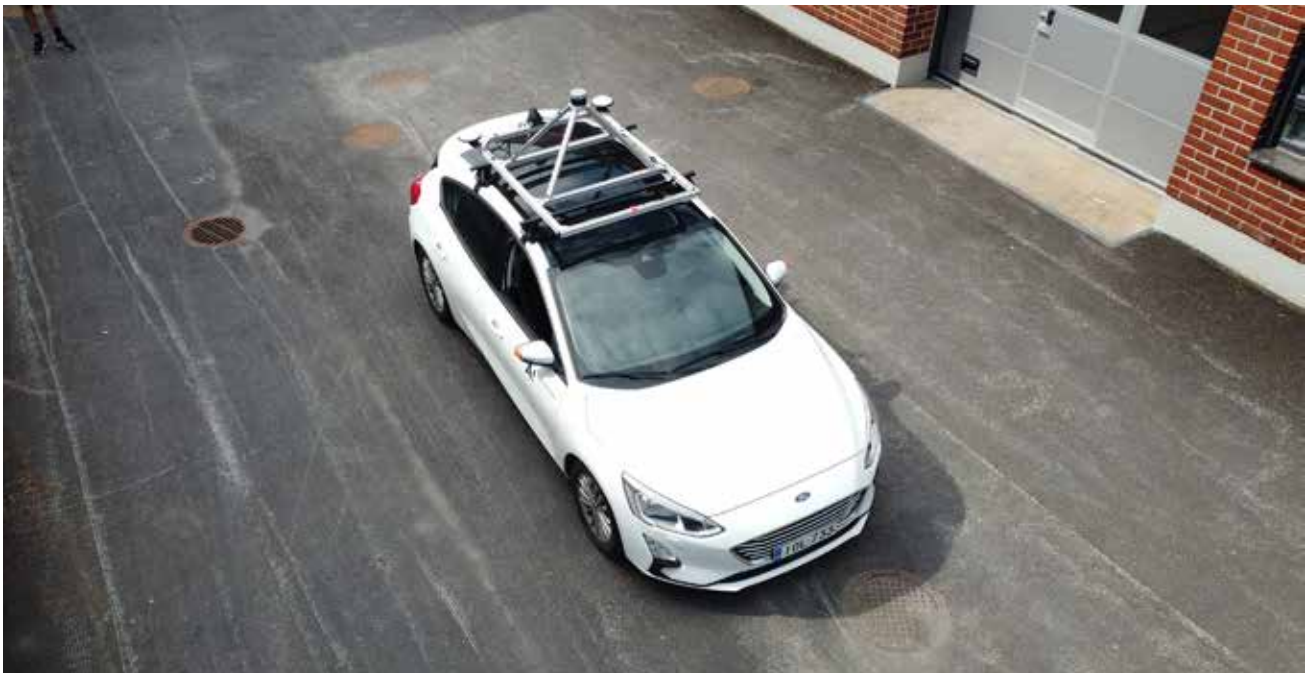
Aalto-yliopiston tutkimusauto on varustettu useilla erityyppisillä antureilla. Autoa on hyödynnetty projektissa verkottuneiden ajoneuvojen tutkimukseen.
