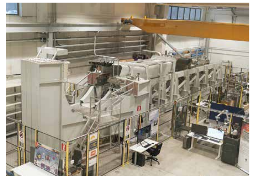
ITER-reaktorin diverttorialueen huollon täysimittainen testiympäristö VTT:n tiloissa Tampereella.
