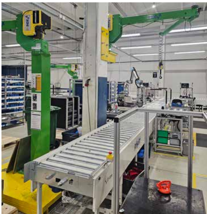
Robotti ja älykkäät Indeva-keventimet helpottavat ihmisen arkea virtautetulla tuotantolinjalla.
