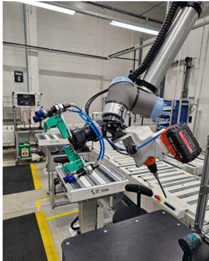
Robottikäsi varteen on integroitu konenäkö, ruuvauslaite, imukuppi- ja sormitarttuja.
