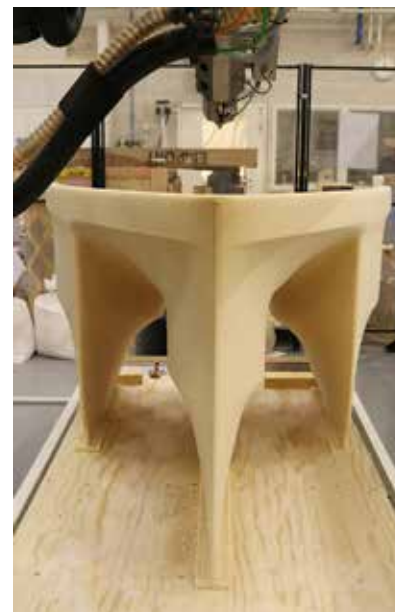
3D-tulostettu trimaraanin rungon osa.
