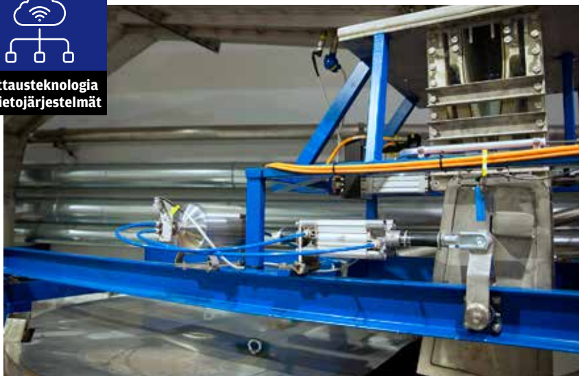
Gravimetrisen laitteiston divertteri muuntaa virtausta, ohjaa vesivirtauksen vaakasäiliöön ja toimii mittausajan määrittämisessä. Viivamainen vesisuihku ohjautuu vaakasäiliöön.
